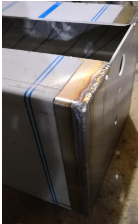
Figura 13. Soldado de estructura con TIG y aporte E 308
